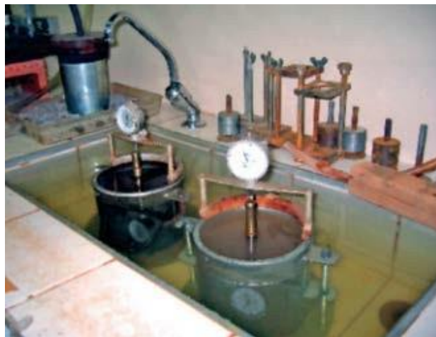
Figura 148 - 2. Medida de expansión axial
