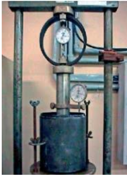
Figura 148 - 3. Ensayo de penetración
